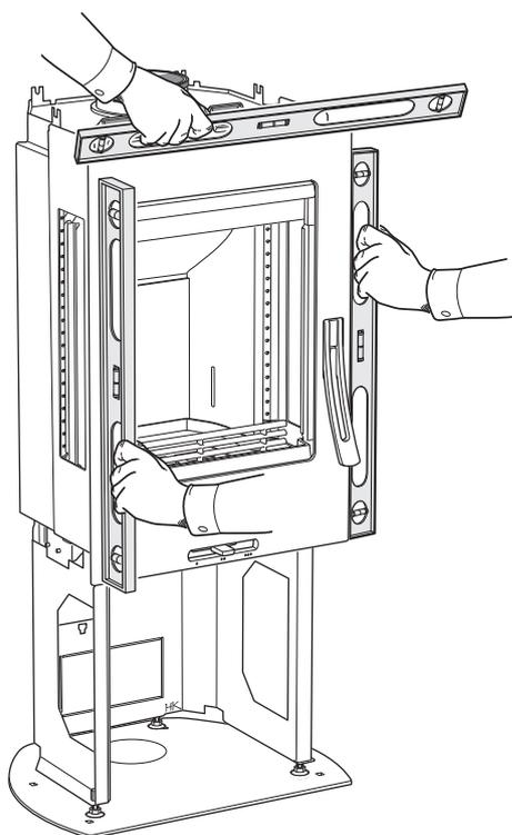
Wenn die Federkraft nicht ausreicht, obwohl die Feder ganz außen am Hebelarm montiert wurde, sollte die Neigung des Kaminofens überprüft werden. Justieren Sie bei Bedarf mit den Stellfüßen.
